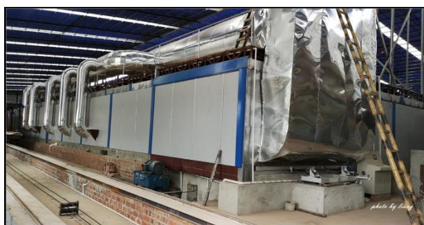
图 4、带有过渡室的平流隧道窑(宜宾)
