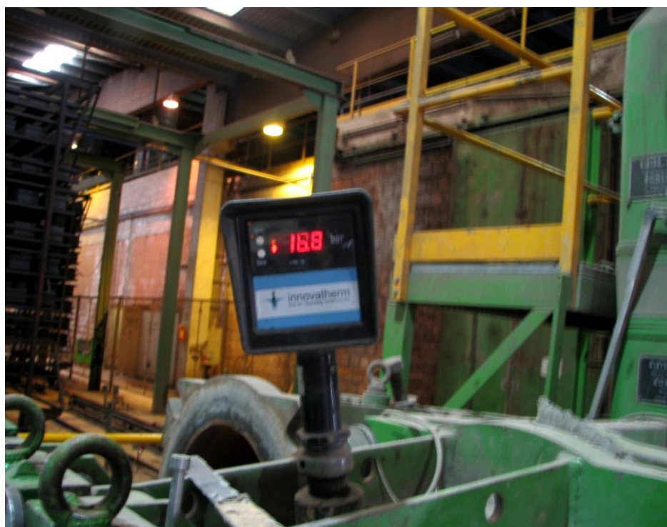
图 18 维也纳山公司的烧结保温隔热砌块成型时的实时挤出压力
