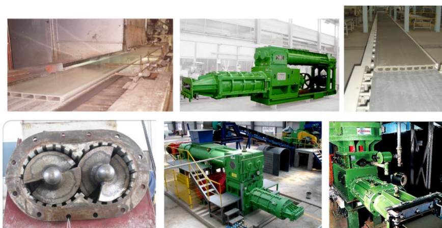
图 8 真空螺旋挤出机生产墙板的资料照片
