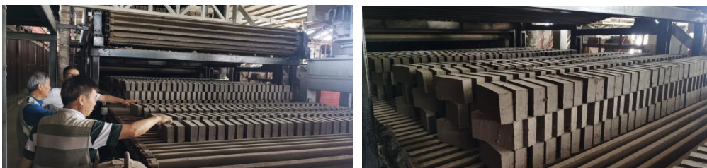
图 12 链板式二次码烧快速干燥窑
