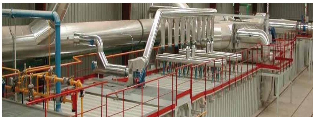
图 13 天然气装配式隧道窑（法国）
