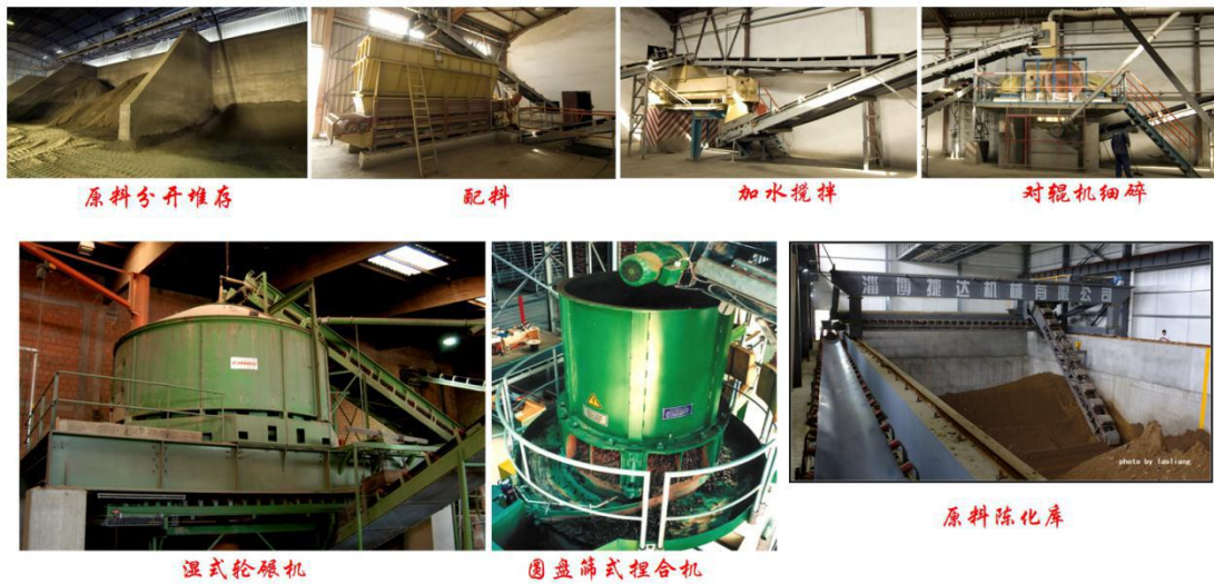
图 7 原料处理的主要流程和设备
